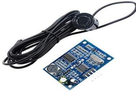
Gambar II. 2 Sensor Ultrasonik JSN SR-04T
