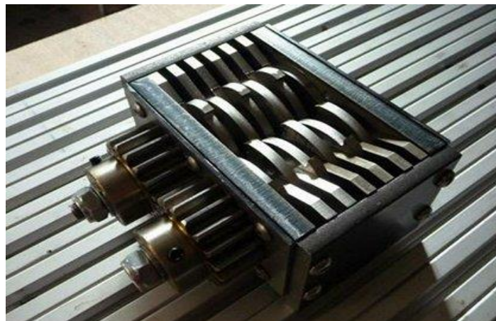
Gambar 2.2 Mata Pisau Mesin Pencacah Sampah
