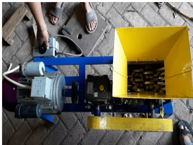
Gambar 4.1 Mesin pencacah limbah sampah dengan sistem shredder
