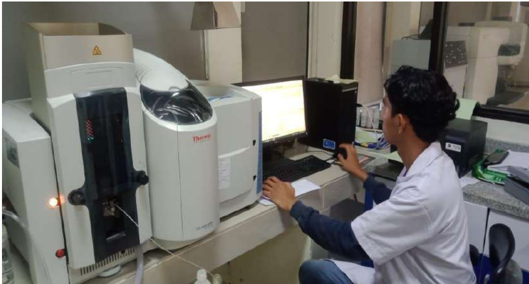
Gambar E 2 Proses pembacaan sampel metode AAS
