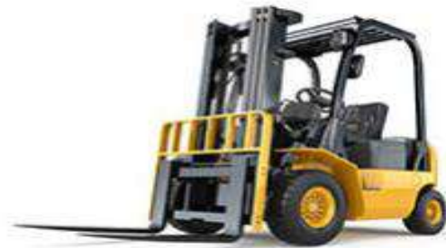
Gambar 2.5 Forklift dengan komponen fork dan mast Sumber (OSHA, 2022)
