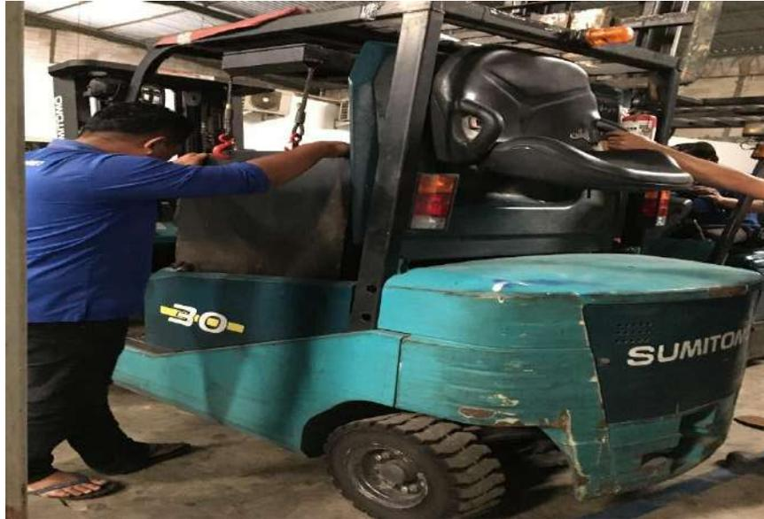
Gambar 17. Proses Penggantian Battery Forklift 3 ton
