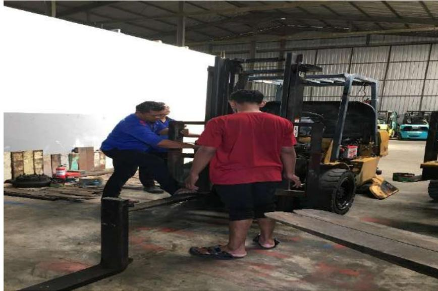
Gambar 15. Proses Pengantian Fork Pada Forklift 3,5 Ton
