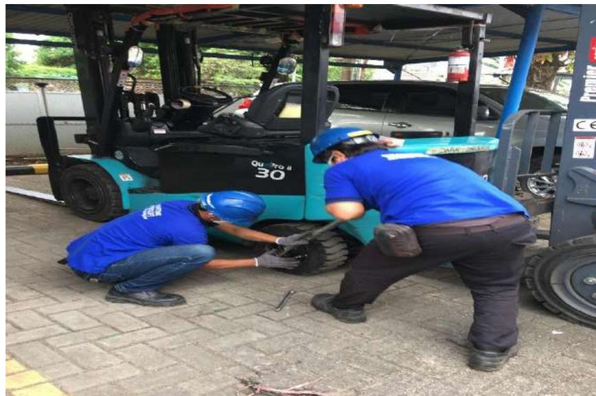
Gambar 16. Proses Pengantian Ban Forklift 3 Ton
