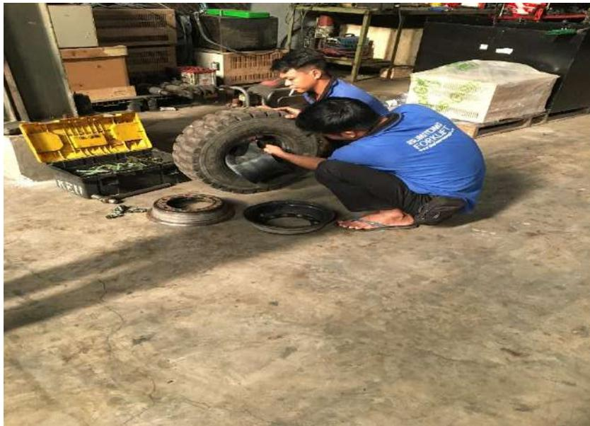
Gambar 6. Proses Pengantian Ban Dalam Forklift 3,5 Ton
