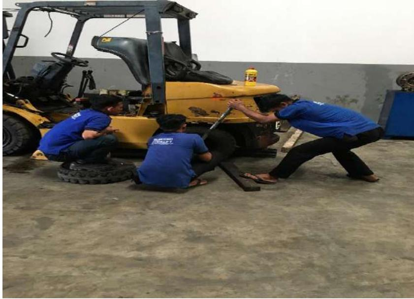
Gambar 7. Proses Pemasangan Ban Forklift 3,5 Ton
