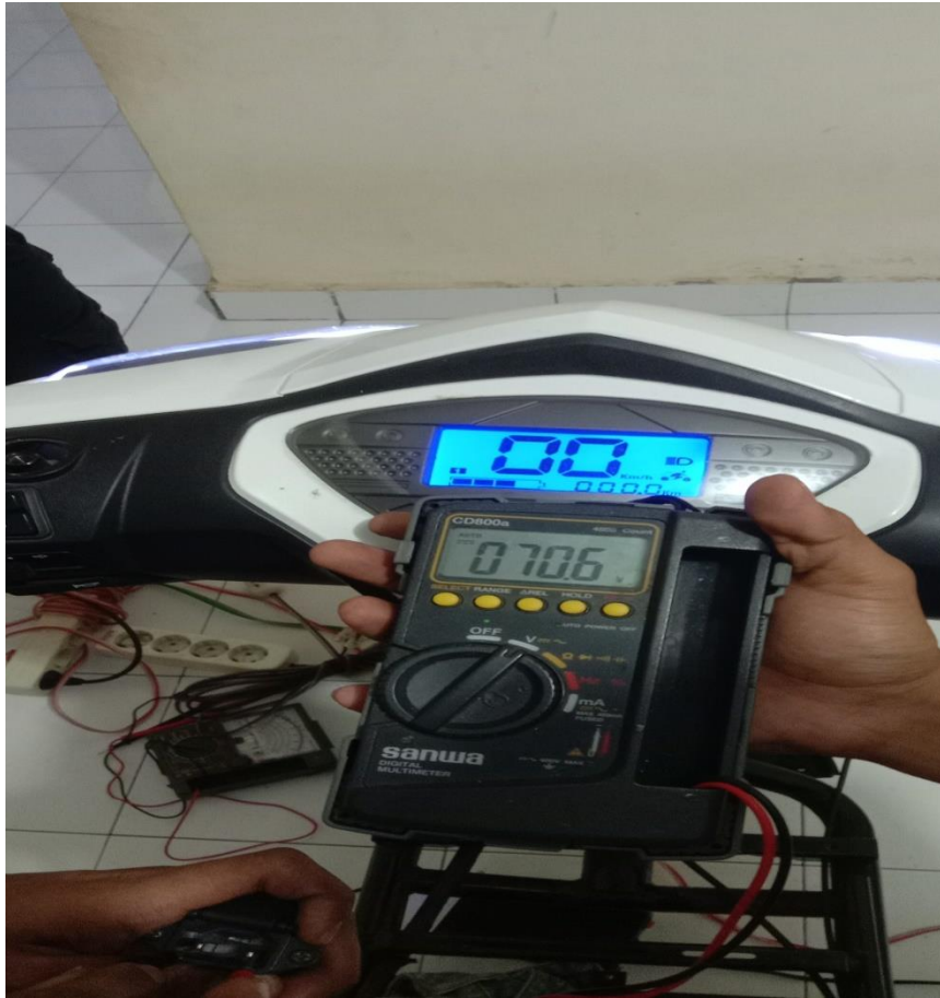
Panel display kondisi baterai 3 bar dan ampere pada amperemeter
