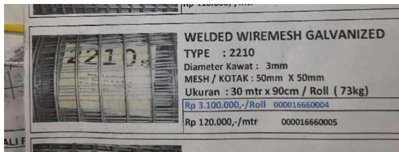
Gambar Il. 3 Diameter wiremesh yang digunakan
