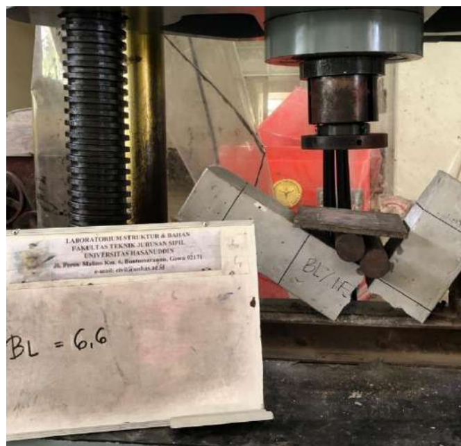
Gambar IV. 8 Pola Retak Balok Limbah Beton tanpa wiremesh
