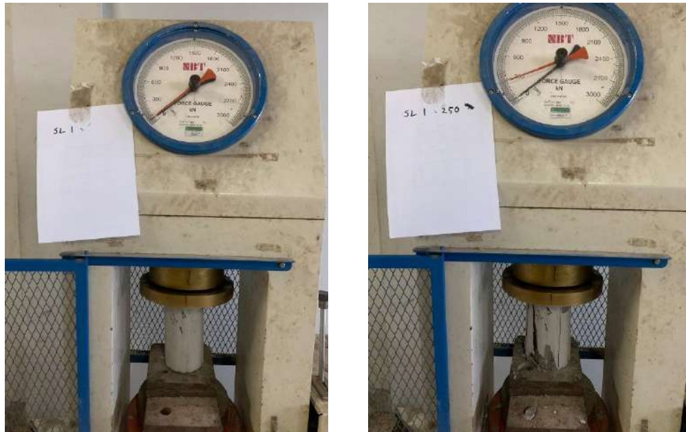
Gambar IV. 2 Pengujian Kuat Tekan Beton SCC (SS)
