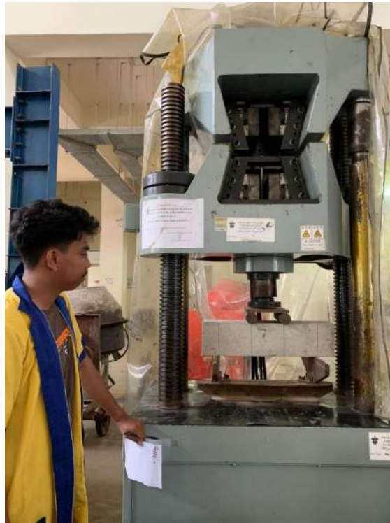
Gambar IV. 4 Pengujian balok Limbah wiremesh
