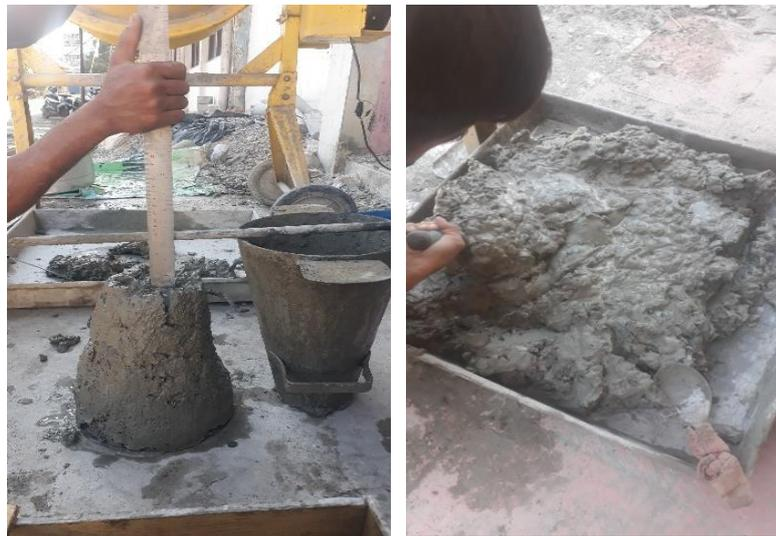
**Gambar IV.1** Hasil Uji Slump
