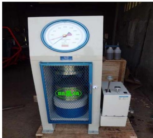
**Gambar III.2** Alat Pengujian Kuat Tekan
