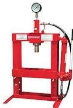
Gambar 2. 2 Mesin pres menggunakan tenaga manual
