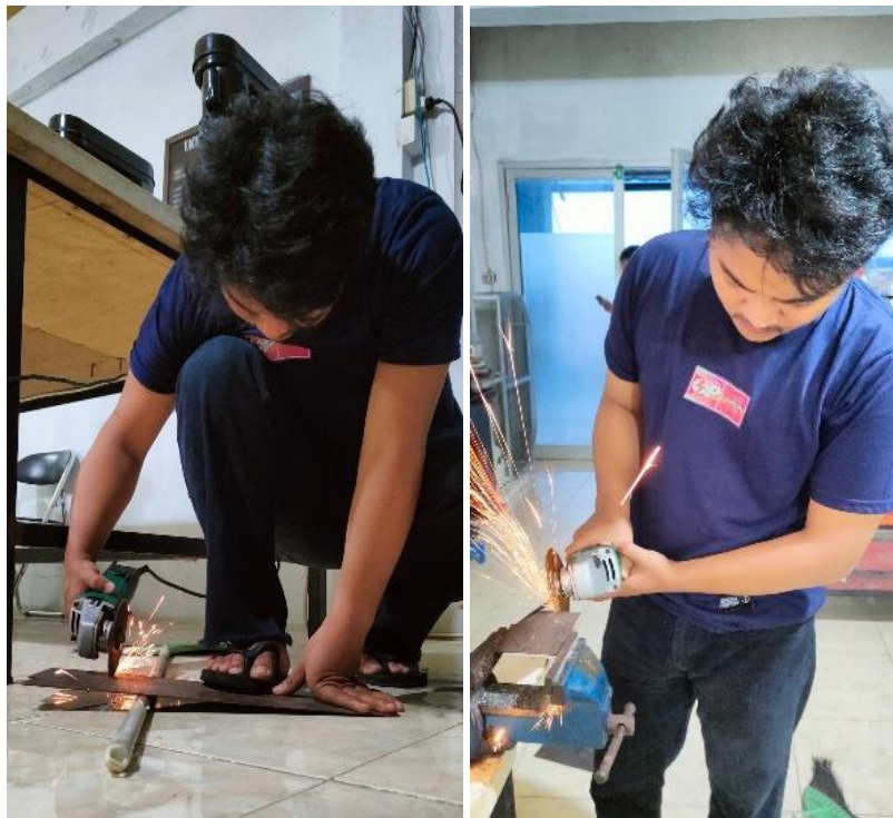
Gambar 4. 1 Pemotongan Besi Plat
