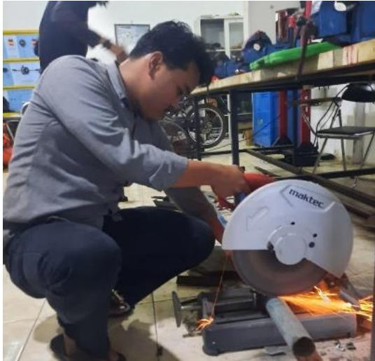
Gambar 4. 2 Pemotongan Besi Pipa
