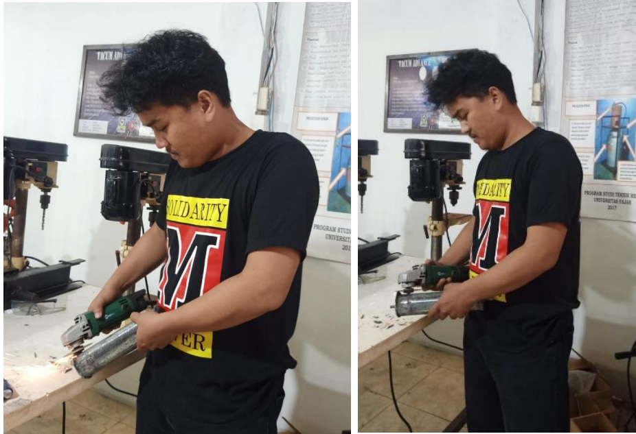
Gambar 4. 4 Penghalusan Plat Penutup Tabung
