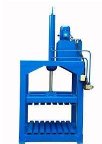
Gambar 2. 1 Mesin pres menggunakan tenaga hidrolik
