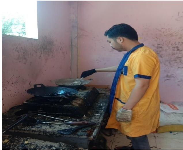
Pengorengan Campuran Agregat
