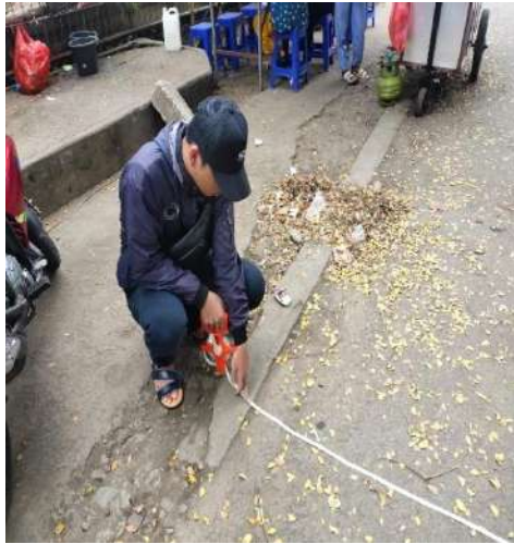
Gambar 4. Pengukuran segmen jalan
