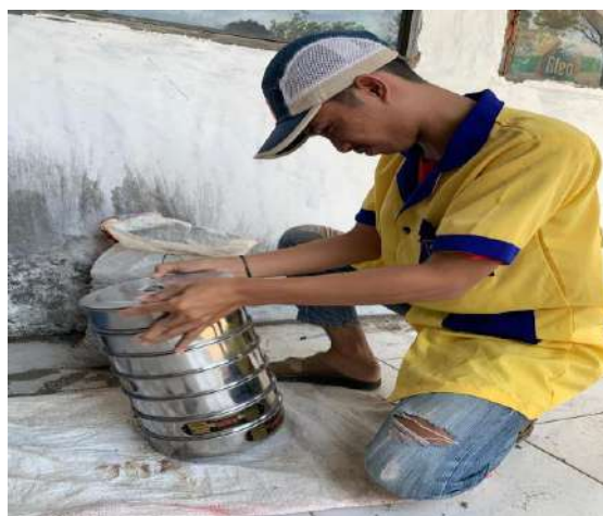
Proses Penyaringan Agregat
