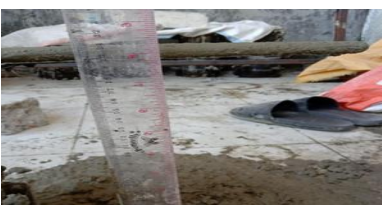
Gambar IV. 6 Pengujian Slump Variasi Fly Ash 15 %
