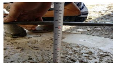
Gambar IV. 7 Pengujian Slump Variasi Fly Ash 25%
