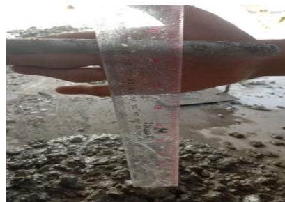
Gambar IV. 5 Pengujian Slump Variasi Fly Ash 10 %
