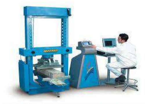
**Gambar III.2 Pengujian Kuat Lentur**
