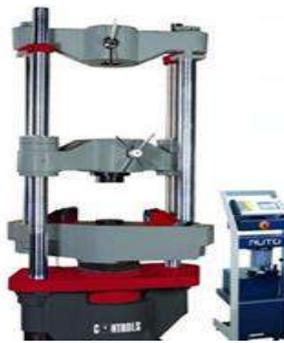
**Gambar III.3 Alat Pengujian Kuat Tarik Baja Tulangan**
