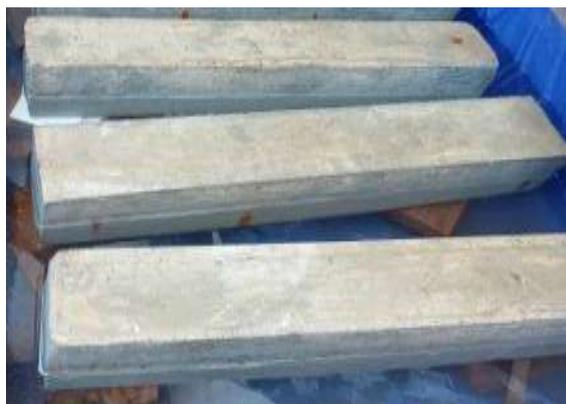
**Gambar II.6** Perendaman Beton Menggunakan Air Laut
