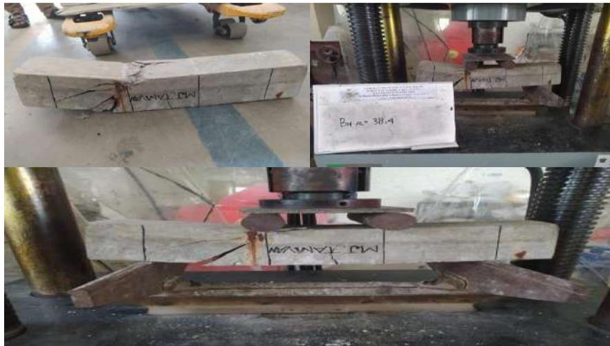
**Gambar IV.2 Pengujian Kuat Lentur Balok**
