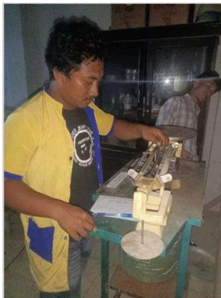
Penimbangan Sebelum Pengujian Marshall
