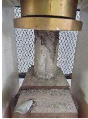
Gambar IV. 1 Pengujian kuat tekan
