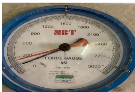
Pengujian kuat tarik belah beton
