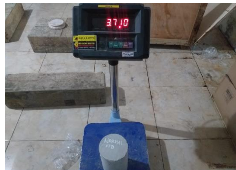
Menimbang beton umur 28 hari
