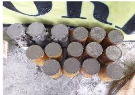
Beton di diamkan selama 24 jam
