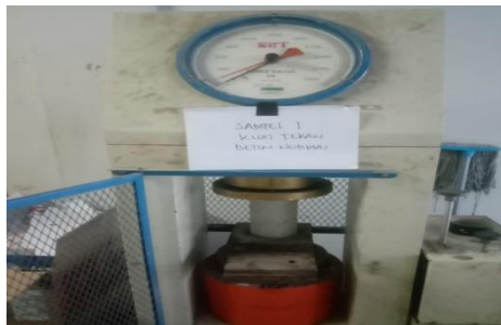
Mesin Uji kuat Tarik belah ( Universal Testing Machine )
