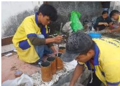
Campuran dimasukkan ke dalam benda uji
