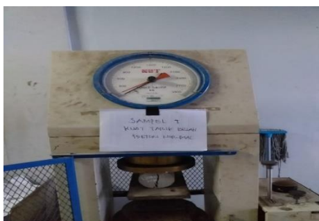
Pengujian kuat tarik belah beton
