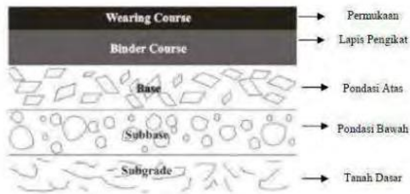
Gambar II. 1 Struktur perkerasan jalan lentur
