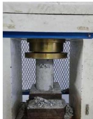
Gambar IV 2 Pengujian Kuat Tekan Beton Silinder Limbah 50%.
