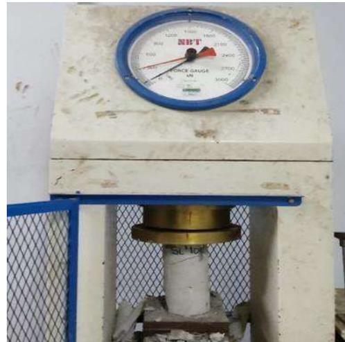
Gambar IV 3 Pengujian Kuat Tekan Beton Silinder Limbah 100%.
