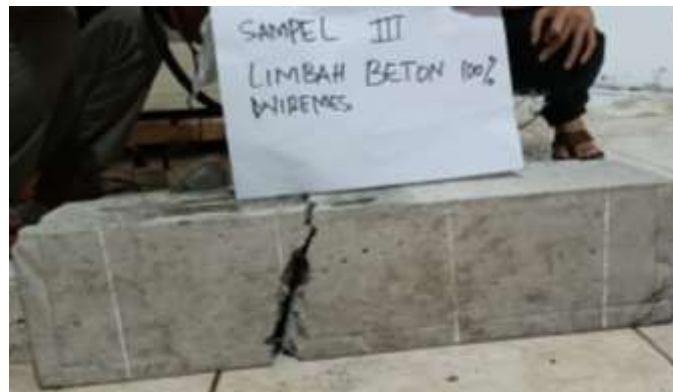
Gambar IV. 23 Pola Retak Benda Uji Balok Limbah Beton Wiremesh Variasi 100% 3
