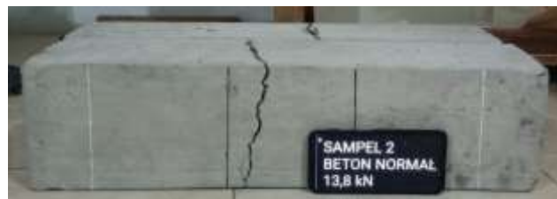
Gambar IV. 9 Pola Retak Benda Uji Balok Beton Normal 2
