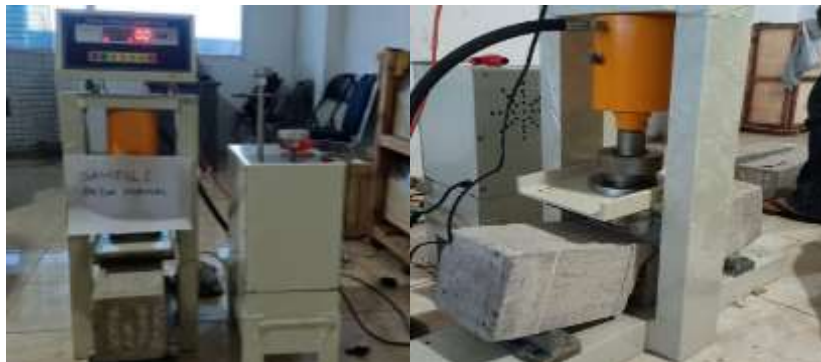
Gambar IV. 3 Pengujian Kuat Lentur Benda Uji Balok Beton Normal
