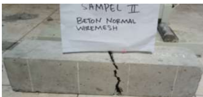
Gambar IV. 15 Pola Retak Benda Uji Balok Beton Normal Wiremesh 2
