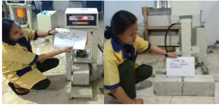
Gambar IV. 4 Pengujian Kuat Lentur Benda Uji Balok Beton Normal Wiremesh
