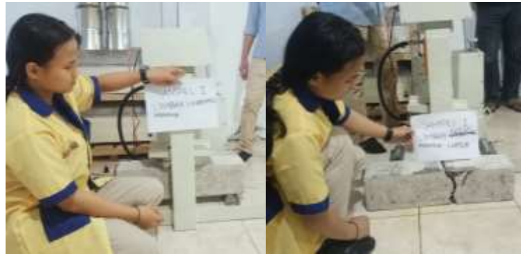
Gambar IV. 5 Pengujian Kuat Lentur Benda Uji Balok Beton Limbah Wiremesh 100%
