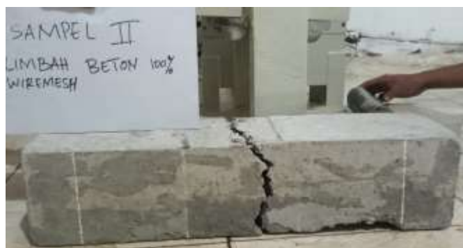
Gambar IV. 21 Pola Retak Benda Uji Balok Limbah Beton Wiremesh Variasi 100% 2
