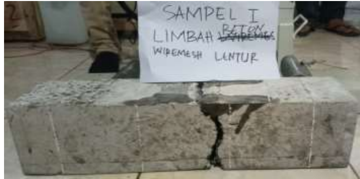
Gambar IV. 19 Pola Retak Benda Uji Balok Limbah Beton Wiremesh Variasi 100% 1
