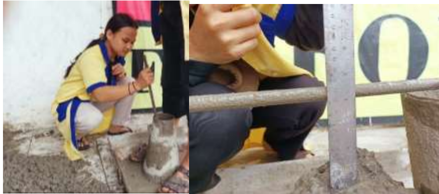
Gambar IV. 1 Pengujian Slump Test (Sumber: Pengolahan Data)
