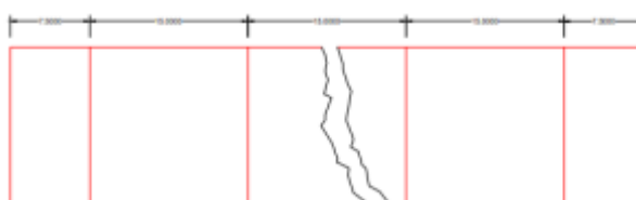
Gambar IV. 15 Pola Retak Benda Uji Balok Beton Normal Wiremesh 2
