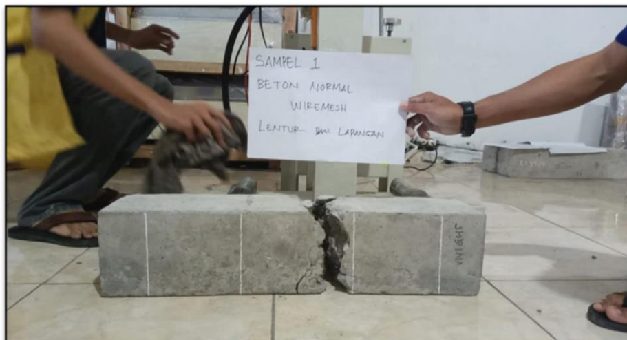
Gambar IV.9 Pola Retak Beton Normal wiremesh 1
