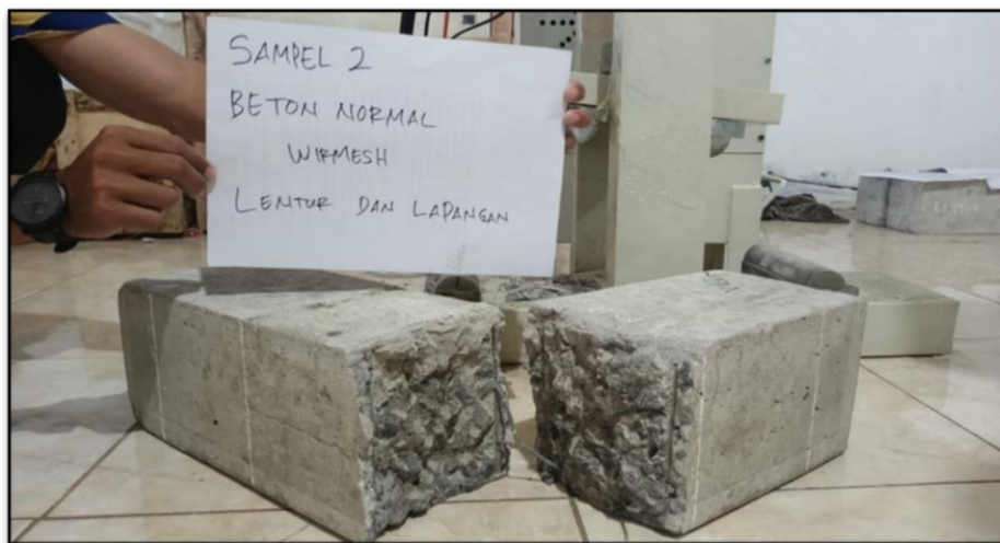
Gambar IV.10 Pola Retak Beton Normal Wiremesh 2
