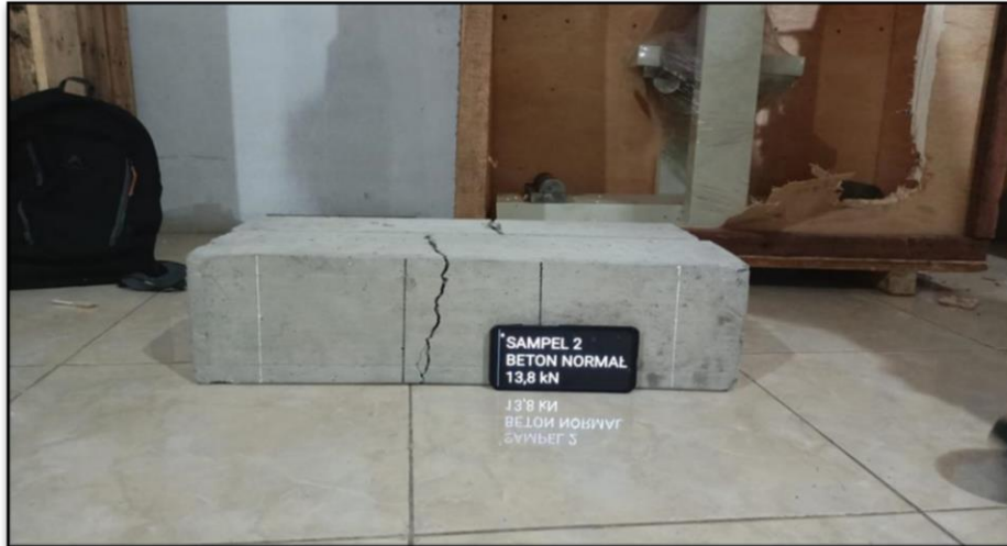
Gambar IV.7 Pola Retak Beton Normal 2
