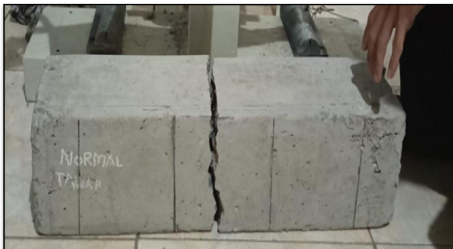
Gambar IV.6 Pola Retak Beton Normal 1
