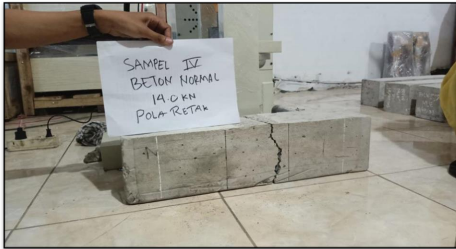
Gambar IV.8 Pola Retak Beton Normal 3
