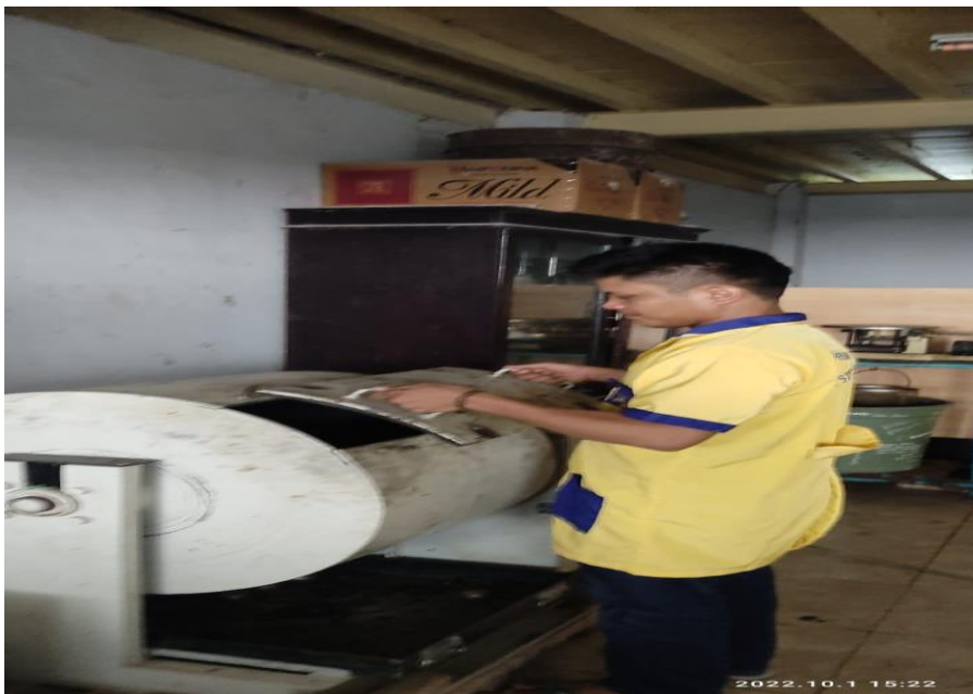
Pengujian cantabro test
