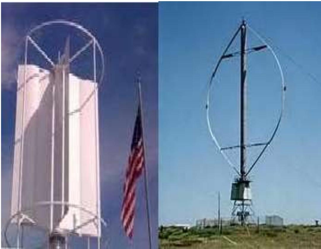
*Gambar II. 5 Turbin Sumbu Vertikal*
