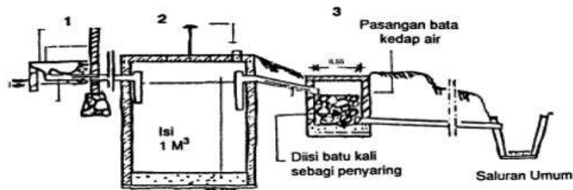
Gambar IV.24 Instalasi Pengelolaan Limbah (Winata, 2016)
