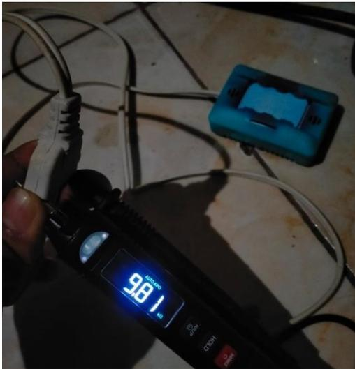
**Gambar 4.7 hambatan pada anti nyamuk elektrik**
