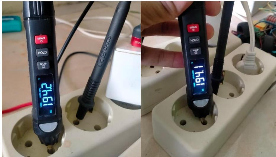
**Gambar 4.23 Tegangan kamar 1 dan 2 pada alat ukur digital**
