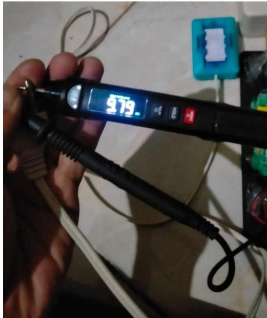
**Gambar 4.15 hambatan pada anti nyamuk elektrik**
