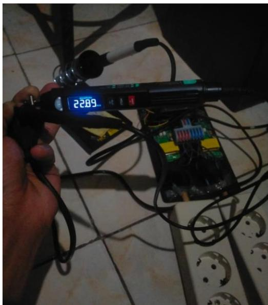
**Gambar 4.11 hambatan pada solder**
