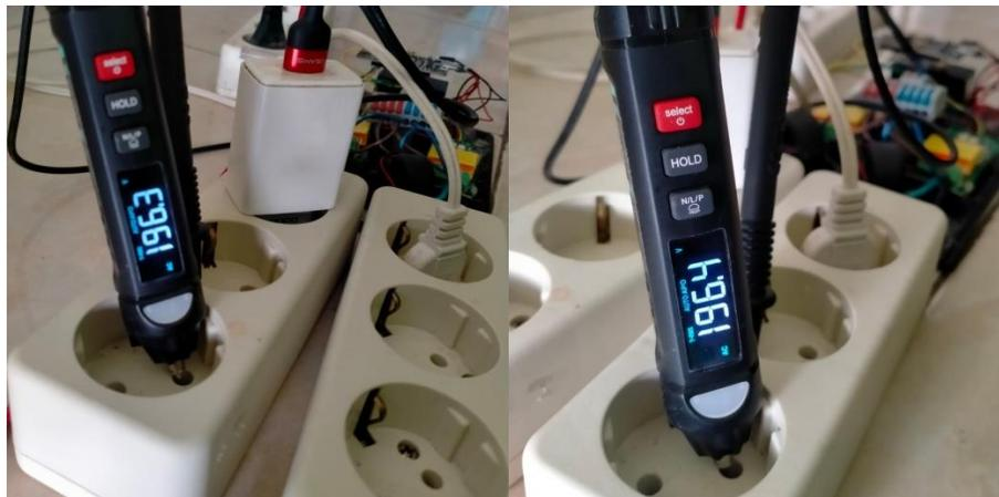
Gambar 4.21 Tegangan kamar 1 dan 2 pada alat ukur digital
