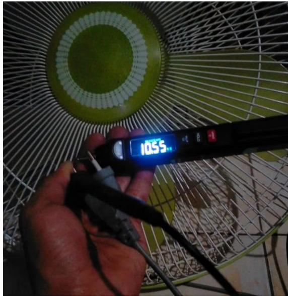
**Gambar 4.19 hambatan pada kipas angin B**
