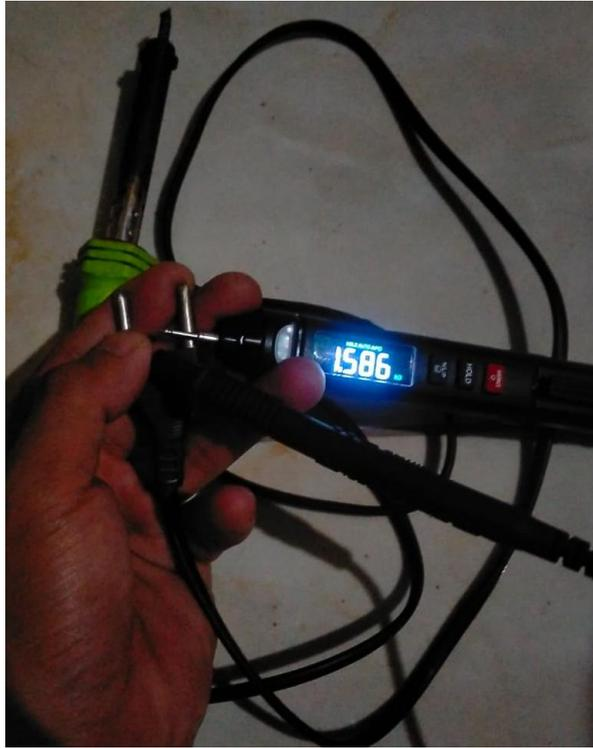
**Gambar 4.18 hambatan pada solder**
