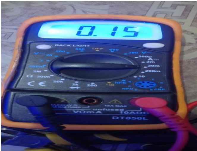
8. Tegangan output kapasitor 3 uF
