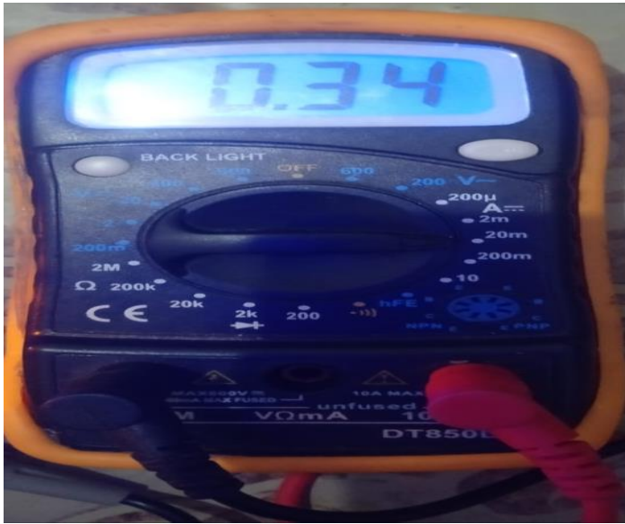
10. Tegangan output kapasitor 6 uF
